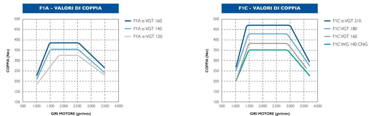
e-VGT: Turbocompressore a geometria variabile e controllo elettronico; VGT: Turbocompressore a geometria variabile; WG: WasteGate; CNG: Gas naturale compresso
